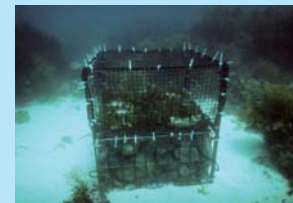
同じ場所に食害防止用の網をかぶせた試験礁を設置。アイゴ・イスズミなどは中に入れない。
